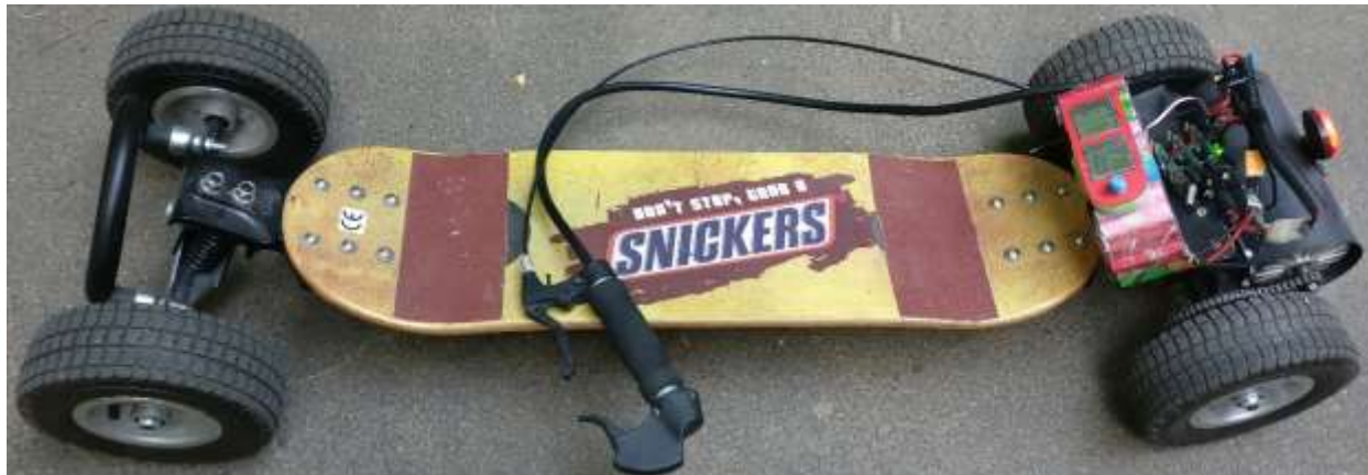
Fig. 10.12: Prezentarea skateboard-ului electric cu motor de curent continuu cu perii
